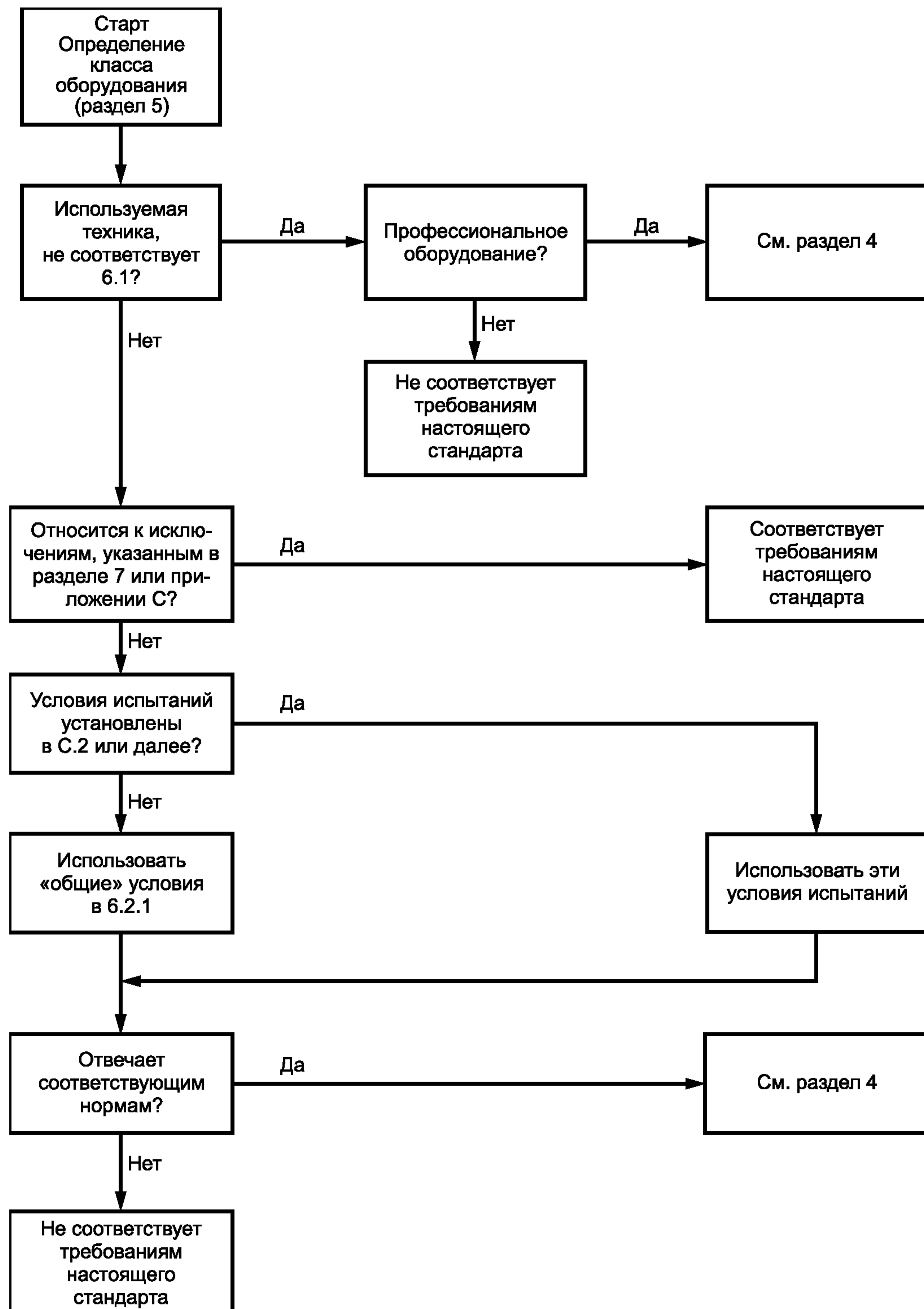
Рисунок 1 — Алгоритм для определения соответствия
